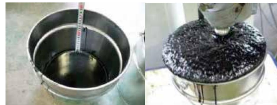
写真 フォームド前のアスファルト(左)とフォームド後のアスファルト(右)
